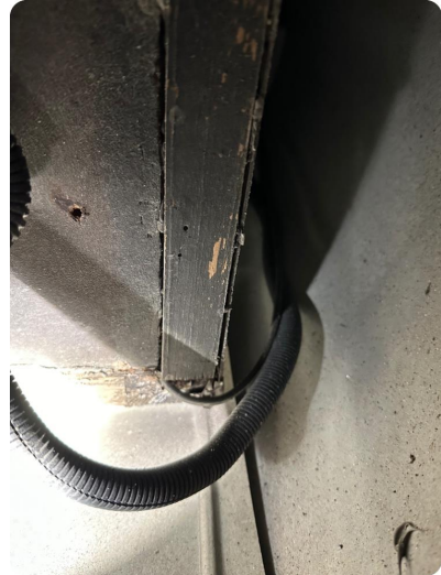
2 Målt fukt i % 80 Kjøretøyet trenger ny gulv i lasterom.
