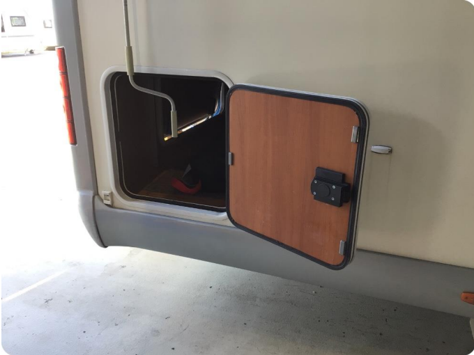
1 Målt fukt i % 75 Fukt i lasteromsluke.
