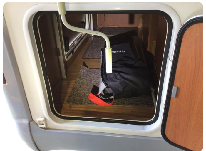
2 Målt fukt i % 80 Kjøretøyet trenger ny gulv i lasterom.
